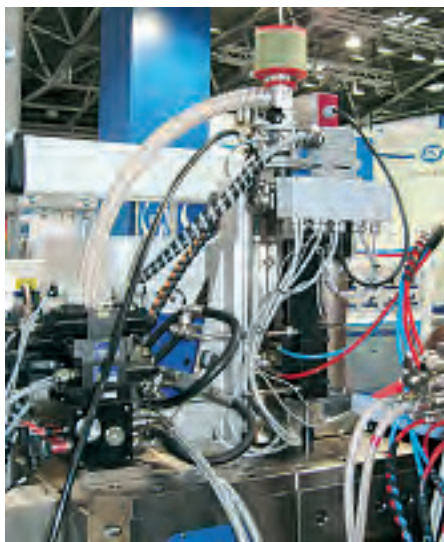
Abbildungen 6 a+b: Detailansichten des Spritzaggregats, oben inklusive Vertikalführung und Servohydraulik für den Einspritzkolben, unten der Servomotorantrieb für die Plastifizierschnecke. Foto: R. Bauer
