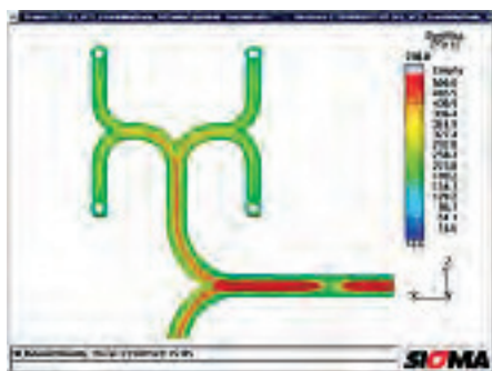
Abbildungen 8 a+b: Zur Schmelzeverteilung werden Mold-Masters -Nadelverschluss-Systeme eingesetzt. Für den Verteilerblock wird die I-flow -Technik eingesetzt, bei der die Verteilerkanäle rheologisch optimal ausgeführt werden können. Foto: R. Bauer
