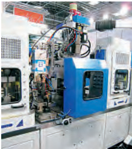
Abbildung 4: Detailansicht des Spritzgießmoduls. Hinter der blauen Schutztür befindet sich die Portalrahmen-Schließeinheit mit einem beiseitigen Durchlass für den Stanzband-Durchlauf und beidseitig abhebenden Formplatten. Das vertikale Spritzaggregat besteht aus einer Schneckenplastifizierung und einem servohydraulisch angetriebenen Kolbenaggregat zum Einspritzen. Foto: R. Bauer
