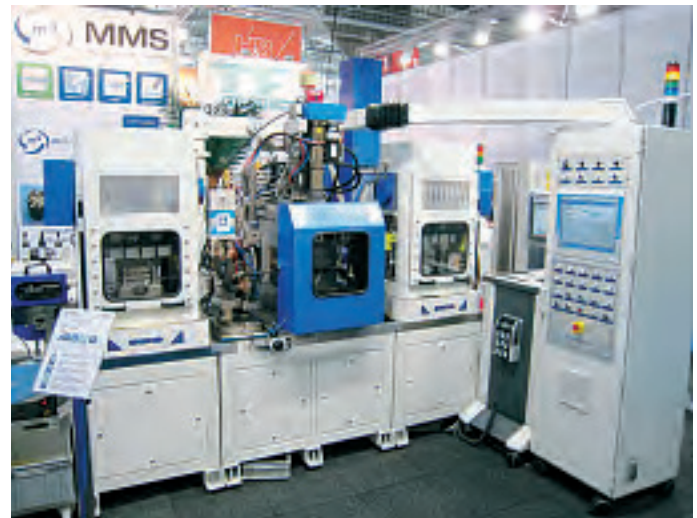
Abbildung 3: Auf einer Grundrissfläche, die einer Spritzgießmaschine im unteren Schließkraftbereich entspricht, bietet das abgebildete MMS-Hybridmaschinensystem vier Bearbeitungsstationen, Spritzgießen inklusive. Maximal können bis zu 12 Stationen kombiniert werden. Foto: R. Bauer
